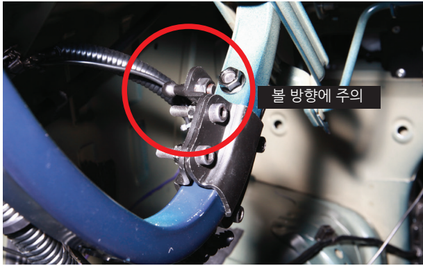
2-7. 브라켓이 고정된 사진. 좌측과 우측 브라켓이 최대한 밀착하도록 고정합니다.
