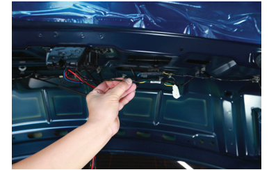
4-4. 순정 래치커넥터를 조립한 후, 리어스위치 연장선을 조립할 곳에 타이를 이용하여 고정.
