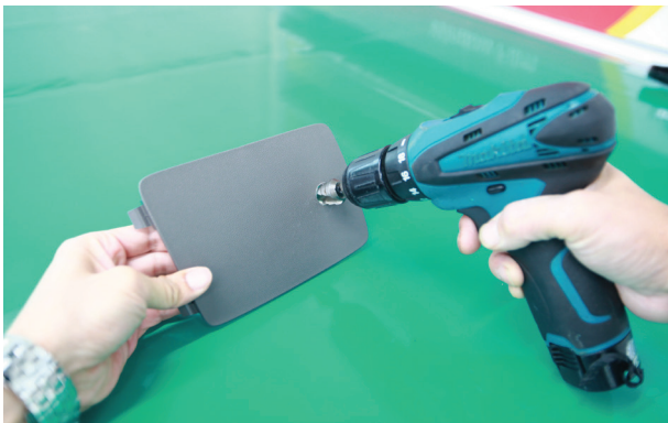
7-3. 동봉된 스위치를 퓨즈커버에 구멍을 뚫어서 고정. (안쪽 배선이나 릴레이에 걸리지 않도록 유의.)
