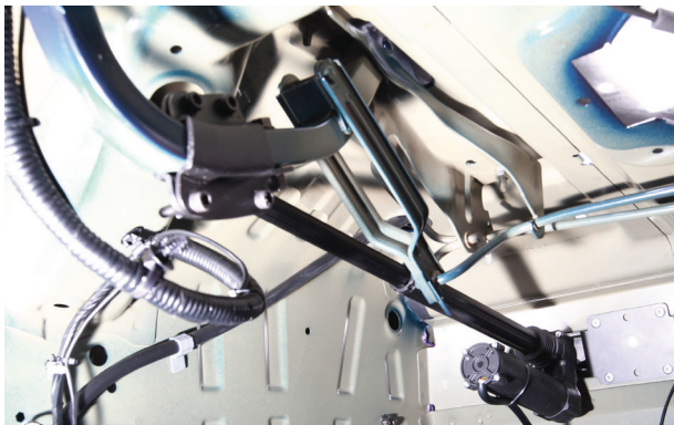
2-9. 좌우를 구별하여 전동풀 장착. 좌측 전동풀 장착완료 사진 (우측 동일 작업.)
