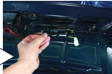
4-4. 래치 케이블을 커넥터에 연결한 후 리어 스위치가 장착될 곳으로 리어 스위치 케이블 선 정리.
