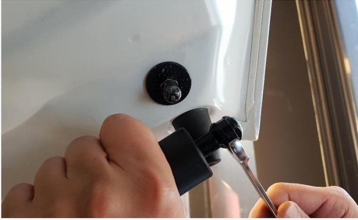
사진과 같이 전동폴이 돌아가지 않도록 꼭 잡은 후 (차체 쪽에 장착된 전동폴의 볼브라켓이 돌아가지 않도록) 스패너를 이용하여 조인트볼과 수직이 되도록 시계방향으로 돌린 후 장착.
