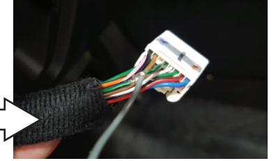
5-7. 순정 프론트 스위치 커넥터의 초록 +검정선에 제품의 전원케이블 회색선을 브릿지(연결).
