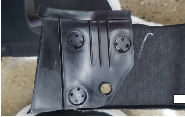
7-4. 트렁크 측면 커버에 사진과 같이 지그를 대고 표시된 곳을 타공한 후에 플라스틱 부분 제거. (좌우 동일 작업)
