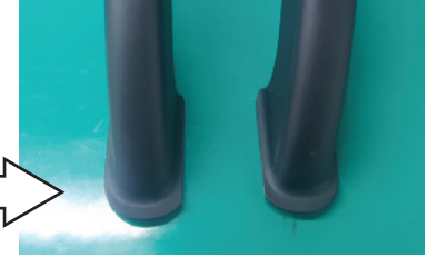
7-2. 사진과 같이 트렁크 리드(천장)커버 측면에 동본된 지그를 대고 표시된 곳을 절단. (A4에 출력된 지그가 작습니다. 점선 표시된 곳까지 절단하세요.)
