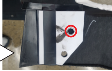
7-4. 트렁크 측면 커버에 사진과 같이 지그를 대고 표시된 곳을 타공한 후에 플라스틱 부분 제거. (좌우 동일 작업)
