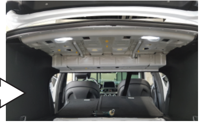
1-7. 표시된 곳의 고무몰딩을 열고, 트렁크 내부 천장 커버의 결쇠를 분리한 후 트렁크 천장 커버 탈거.
