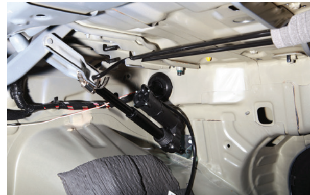
2-12. 전동풀이 장착된 사진. 반대편도 동일하게 장착. 이때 모터 방향에 주의.
