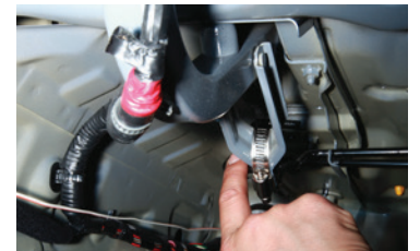
2-6. 차량에 설치되어 있는 BAR 스프링을 공구를 이용하여 화살표 방향으로 밀어준다. 손으로 가리키는 곳이 전동폴이 장착될 위치.
