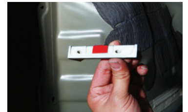
2-5. 2-3의 ③, ④ 번은 동봉된 드릴 가이드 지그를 이용하여 타공후 리벳핀으로 고정.
