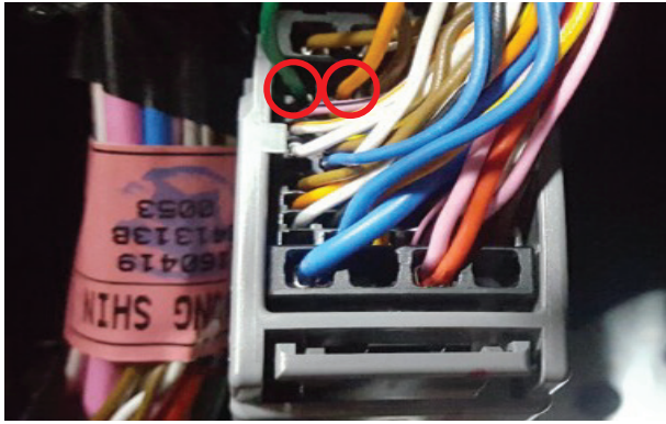
MF11 메인과 플로어 하네스 연결 커넥터 - 60 Female / Black ( AMP_025060110_60F_B_ ) 메인 하네스
