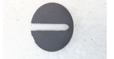
7-3. 테스트 동작을 한 후 이상이 없을시 스트라이커 덮개 윗부분을 그림과 같이 절개.
