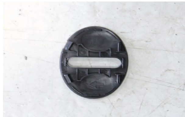
7-3. 테스트 동작을 한 후 이상이 없을시 스트라이커 덮개 윗부분을 그림과 같이 절개.
