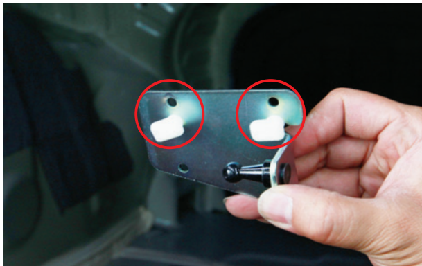
2-2. 해당 브라켓에 동봉된 전동폴 브라켓 지그를 사진과 같이 조립.
