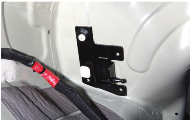
2-3. 전동폴 브라켓 장착 사진.
