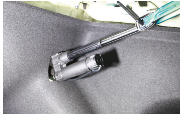
7-8. 연결한 선을 보이지 않게 밀어 넣은 후 조인트 볼에 전동풀을 장착
