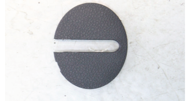
8-3. 테스트 동작을 한 후 이상이 없을시 스트라이커 덮개 윗부분을 그림과 같이 절개. (절개시 간섭을 확인하며 최소절개) ※ 차량에 따라 간섭이 틀리니 확인 요망.
