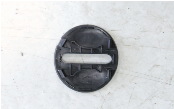
8-3. 테스트 동작을 한 후 이상이 없을시 스트라이커 덮개 윗부분을 그림과 같이 절개. (절개시 간섭을 확인하며 최소절개) ※ 차량에 따라 간섭이 틀리니 확인 요망.
