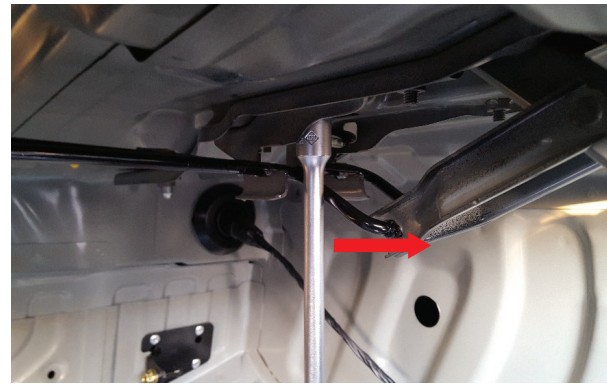
7-2. 차량에 설치되어 있는 BAR 스프링을 공구를 이용하여 화살표 방향으로 밀어준다.
