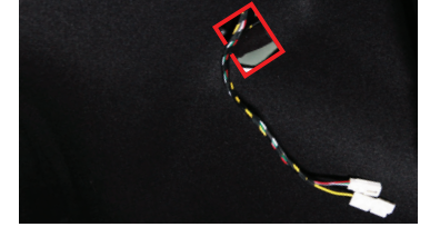
7-1. 휠다커버를 조립. 브라켓의 조인트 볼과 전동풀이 조립될 수 있도록 커버를 절개. 절개한 구멍으로 전동풀 연장선을 빼놓는다.
