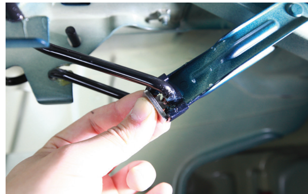
7-3. BAR 스프링과 트렁크 힌지 리드가 분리되지 않도록 스프링 고정핀을 삽입합니다.
