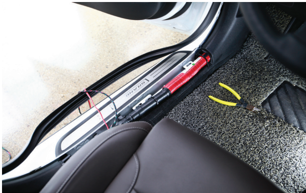
5-5. 앞좌석 및 뒷좌석의 도어 하단에 고무몰딩과 도어 실 트림을 분리하고 순경 배선라인에 전원 선을 케이블 타이로 묶어 배선 정리.
