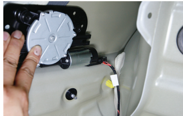
6-2. 스트라이커 구동모터의 커넥터에 메인케이블 연결 후 구동모터를 트렁크 좌측 적당한 위치에 고정.
