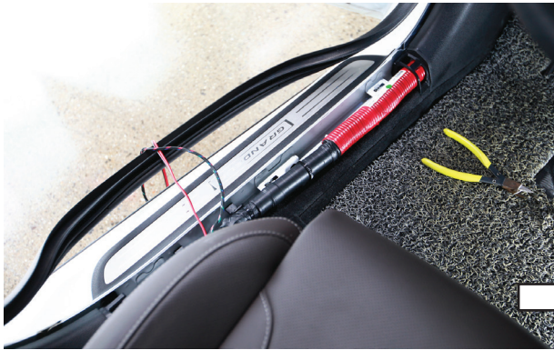
5-5. 앞좌석 및 뒷좌석의 도어 하단에 고무몰딩과 도어 실 트림을 분리하고 순정 배선라인에 전원 선을 케이블 타이로 묶어 배선 경리.
