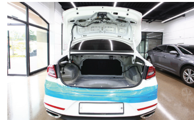
1-14. 표시된 곳의 고정핀을 분리한 후, 트렁크 리드 커버 탈거. 트렁크 내장재 탈거 완료.
