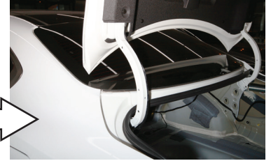
1-12. 표시된 두 곳의 고정핀을 분리하여 트렁크 힌지 커버 탈거. (좌우 동일 작업)
