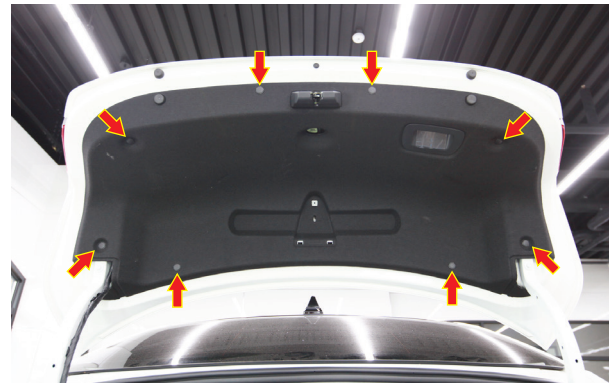
1-14. 표시된 곳의 고정핀을 분리한 후, 트렁크 리드 커버 탈거. 트렁크 내장재 탈거 완료.
