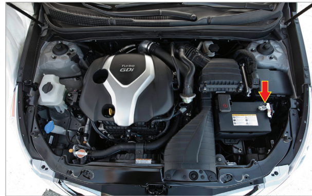
6-5. 작업 전 분리했던 배터리의 (-) 플러그 연결.
