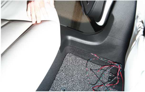
5-4. 전원선과 비상스위치 선을 커버 안쪽으로 숨겨 앞쪽으로 매설. 시트는 다시 고정.
