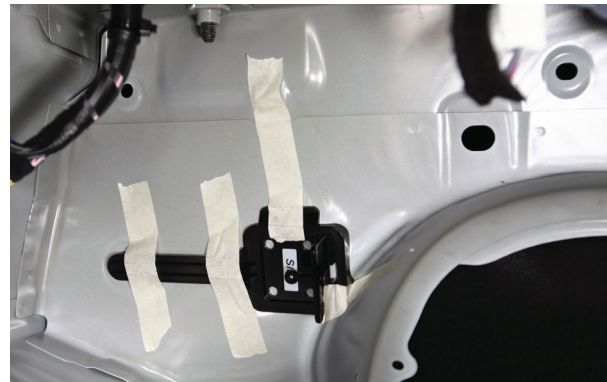
2-11. 사진과 같이 지그의 위치를 고정한다. 이때 브라켓 지그와 순경 철판면이 딱 맞게 고정시켜야 함.
