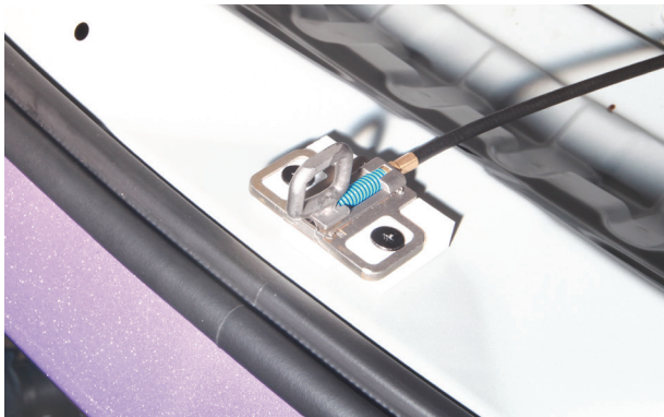
3-2. 볼트와 와셔, 브라켓을 이용해 순경 위치에 제품의 스트라이커 고정. (3-3 설명 참고.) (순경 볼트 사용)
