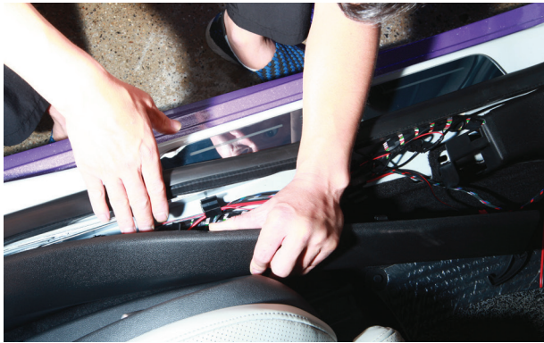
5-5. 앞좌석 및 뒷좌석의 도어 하단에 고무몰딩과 도어 실 트림을 분리하고 순정 배선라인에 전원 선을 케이블 타이로 묶어 배선 정리.
