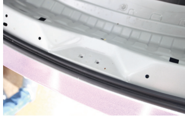
3-2. 볼트와 와셔, 브라켓을 이용해 순경 위치에 제품의 스트라이커 고정. (3-3 설명 참고.) (순경 볼트 사용)
