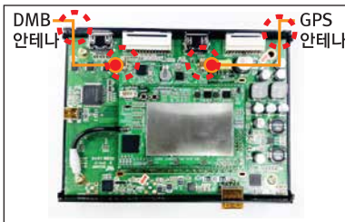
02. 그림과 같이 GPS안테나, DMB 안테나를 연결한 후 홈으로 선을 뽑아 낸 후 덮개를 덮습니다.
