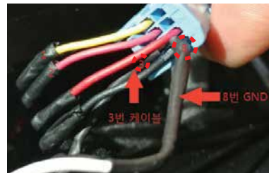
1번 선은 인터페이스 보드의 AUDIO_L 선과, 2번 선은 인터페이스 보드의 AUDIO_R 선과, 3번 Aux Detect 선은 인터페이스 보드의 AUX_DET 케이블과, 8번 GND선은 인터페이스 보드의 AUDIO_GND케이블과 T자로 연결
