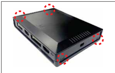
01. NBOX5000 본체의 덮개를 표시된 곳을 눌러 탈거 합니다.
