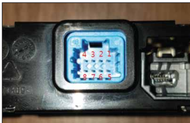
커넥터의 3번 핀이 AUX Detect Pin, 8번 핀이 GND
